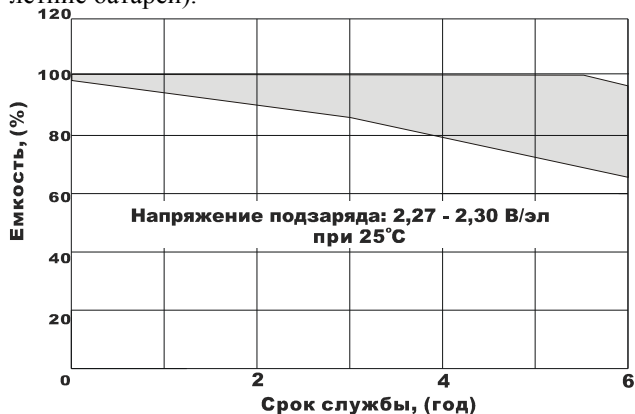
Рис 6.1. Срок службы в буферном режиме работы (5-летние батареи).
